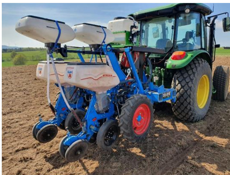
Figure 51: semoir « Zip Drill », développé par Thierry Stokkermans de l'université de Wageningen.
