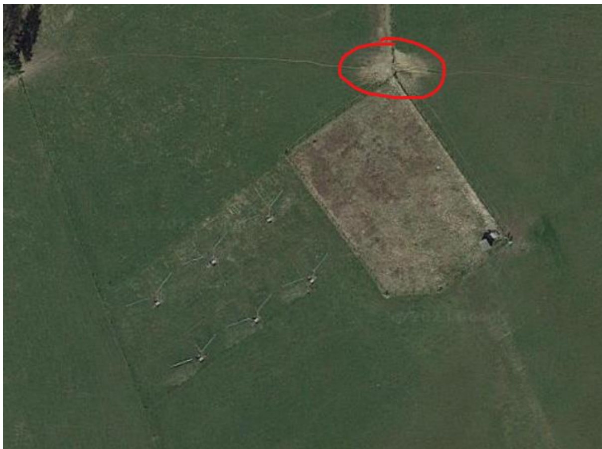
Figure 18 : zone boueuse (entourée), fortement piétinée, à l'angle nord de la clôture autour du captage de Delsalle
